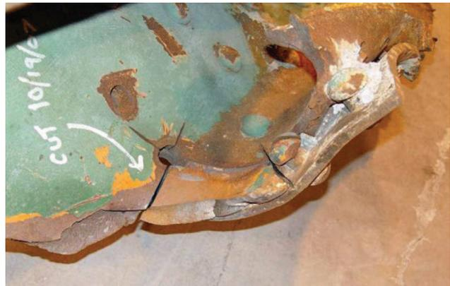
Fig. 10 - I35W, crollo del ponte sul fiume Missisipi, Missouri (2007): dettaglio di alcune cricche diffuse da un giunto rivettato. *I35W, collapse of the bridge on the Missisipi river, Missouri (2007): some crack detail on a riveted joint.*
